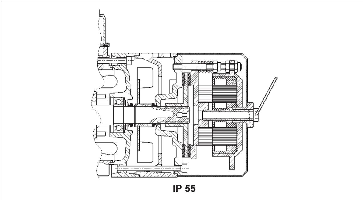
Электромагнитный тормоз с питанием от трехфазной сети **переменного тока** закреплен болтами на корпусе двигателя.
