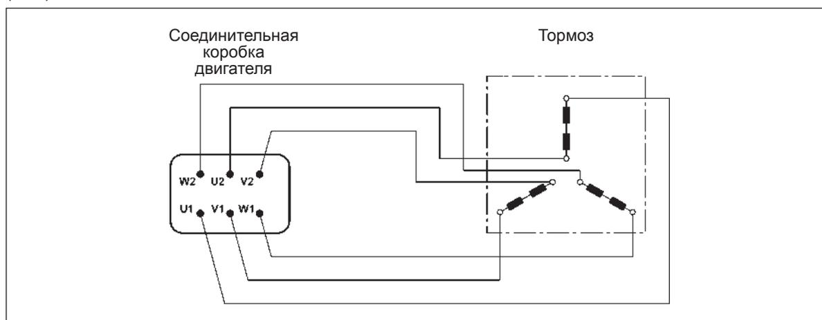
Двухскоростные и изготавливаемые по специальным заказам односкоростные электродвигатели с автономным питанием имеют в соединительной коробке дополнительный шести-контактный выводной щиток электропитания тормоза. Электродвигатели таких модификаций оснащаются соединительными коробками большего размера. См. схему (F55):
