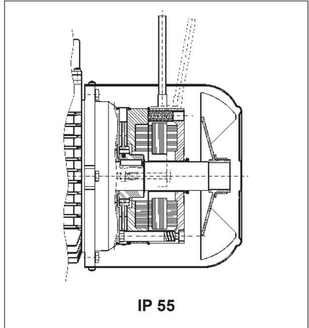
Электромагнитный тормоз с питанием от трехфазной сети переменного тока закреплен болтами на корпусе двигателя. Осевое расположение электромагнита обеспечивается пружинами с предварительным натягом.
