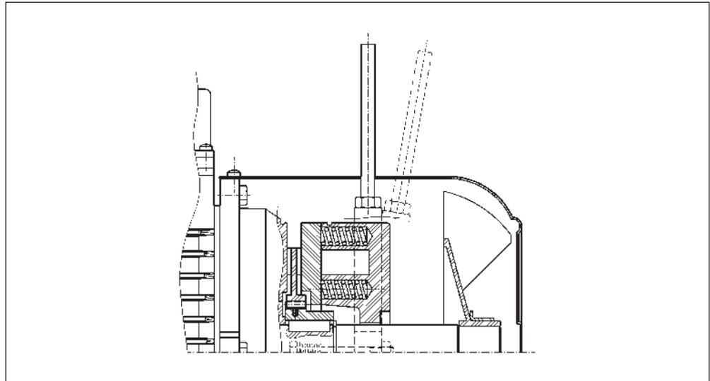
На электродвигателях BN\_FD в исполнении RM рычаг ручной разблокировки тормоза фиксируется в положении «разблокировано» путем завинчивания рычага до его зацепления за выступ корпуса тормоза.
