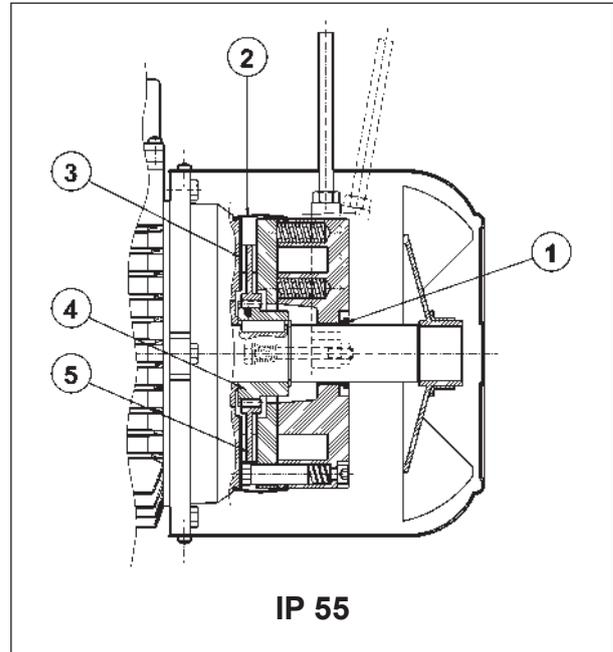
Электромагнитный тормоз **постоянного тока** с тороидальной катушкой закреплен болтами на корпусе двигателя.
