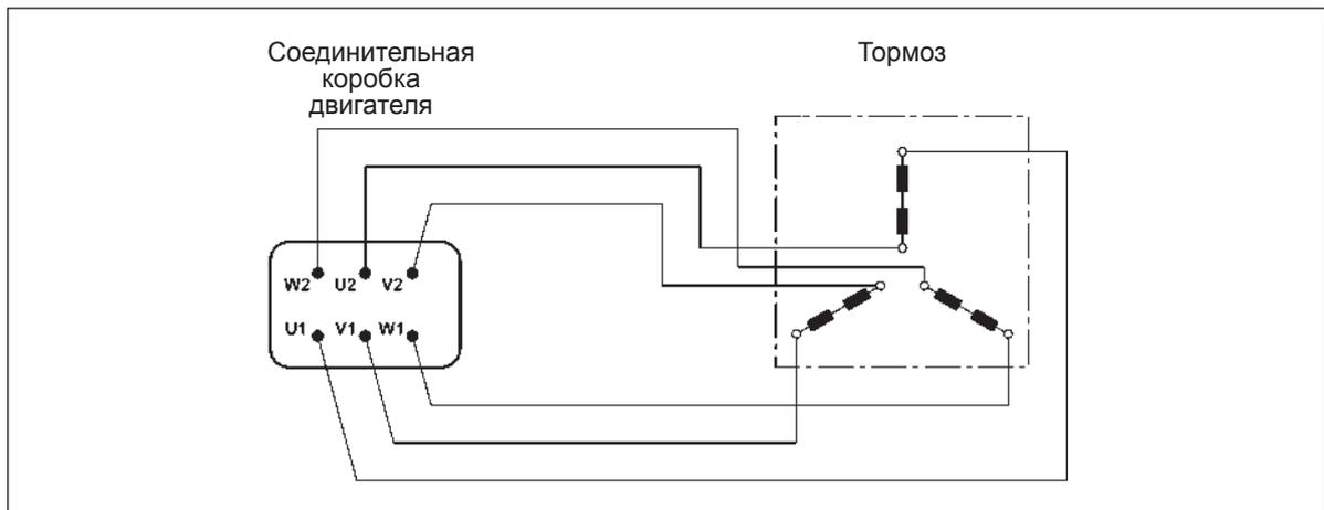
Двухскоростные и изготавливаемые по специальным заказам односкоростные электродвигатели с автономным питанием имеют в соединительной коробке дополнительный шестиконтактный выводной щиток электропитания тормоза.
